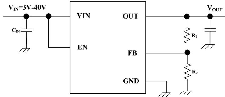
注：图中输出电压由以下公式决定： $V_{OUT} = \left(1 + \frac{R_1}{R_2}\right) \times V_{FB}$ ，其中下电阻 R2 我们推荐使用 650kΩ，误差不大于 1%，温度系数小于 100ppm 的电阻。
