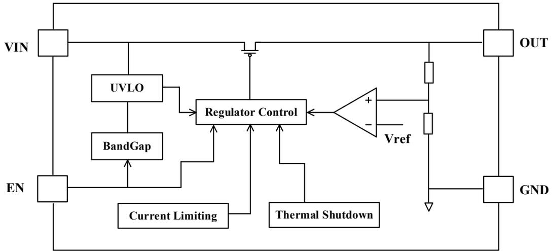
图 2 SIT14503Q 固定输出系列内部框图
